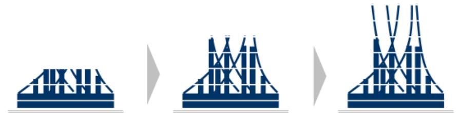
➔ ...den schichtweisen Aufbau eines Bauteils ohne Werkzeuge aus einem digitalen Modell
